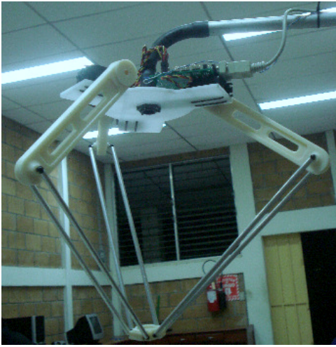
Fig. 12. Prototipo del Robot Paralelo Delta.
