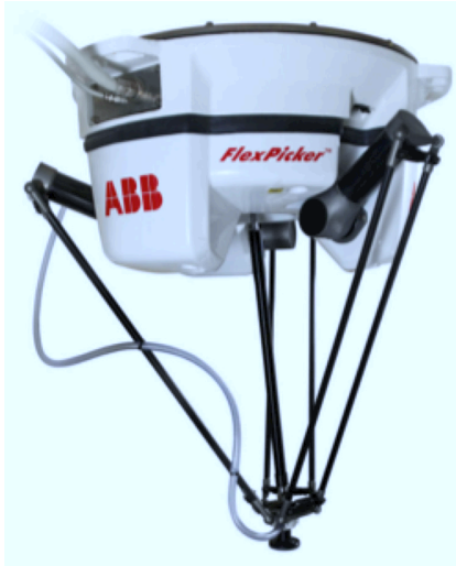
Fig. 1. Robot Paralelo Delta FlexPicker de ABB.
